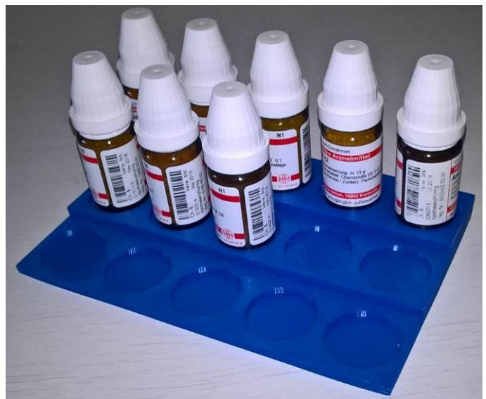
Abbildung: Tablett als Globulihalter, Ausdruck ca. 11 Stunden
